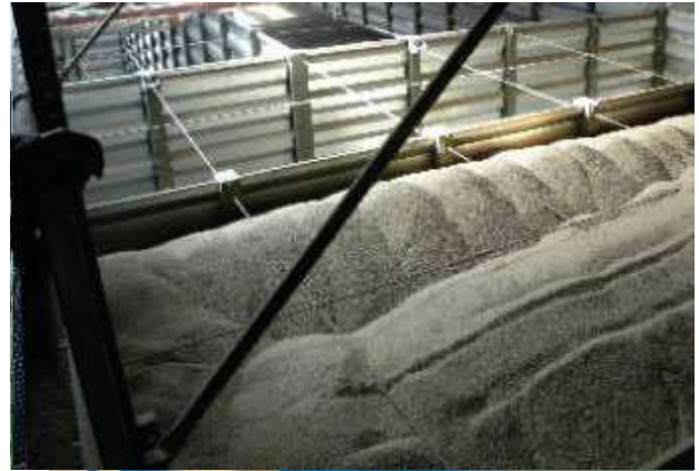
Spunsvæg - enkel montage med håndterbar dele.
