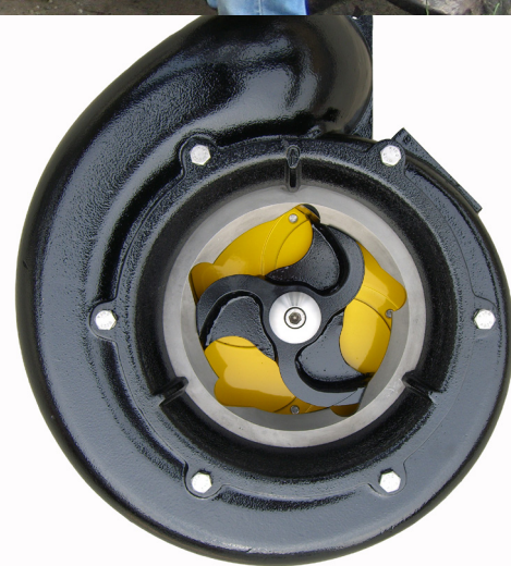
Pumpehus i støbejern med knivskær
