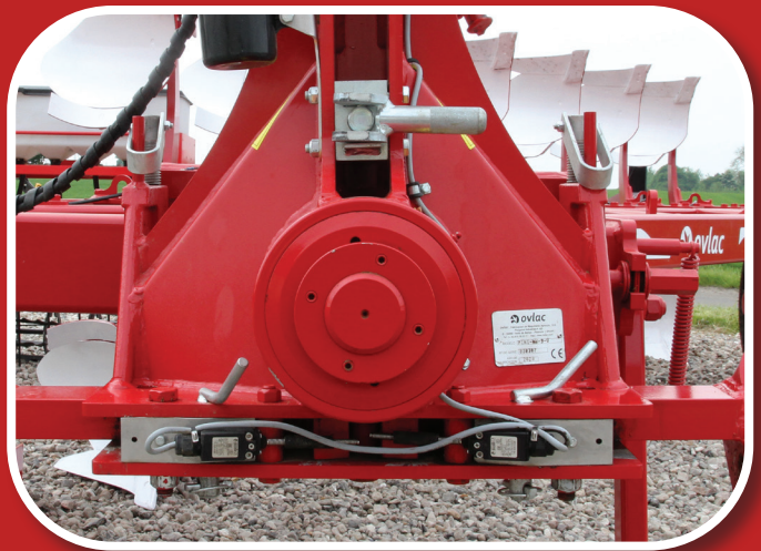
Automatisk til og fra kobling af såmaskine via føler på løs bæreaksel
